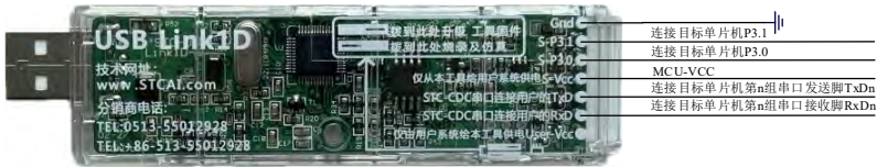
USB Link1D工具: 支持全自动停电-上电在线下载 / 脱机下载 / 仿真
