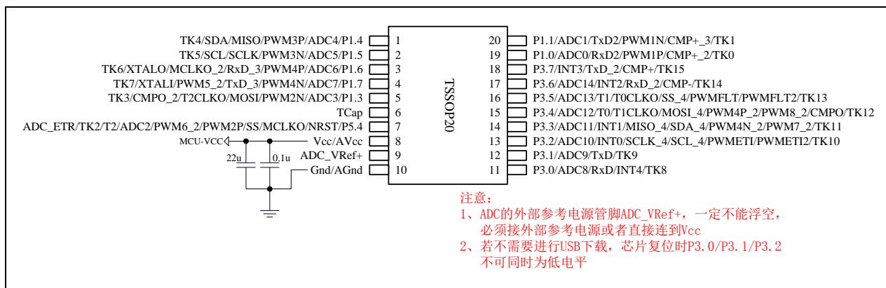
建议在 Vcc 和 Gnd 之间就近加上电源去耦电容 22uF 和 0.1uF, 可去除电源线噪声, 提高抗干扰能力
