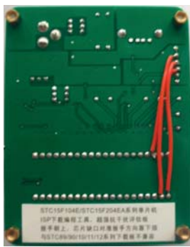
STC15系列单片机ISP下载编程工具反面 (注意有“STC15F104E/STC15F204EA系列”字样)
