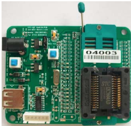
SOP-28转换座的安装
