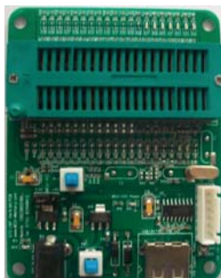
STC12/11/10/89/90系列16-pin单片机ISP下载编程工具正面
