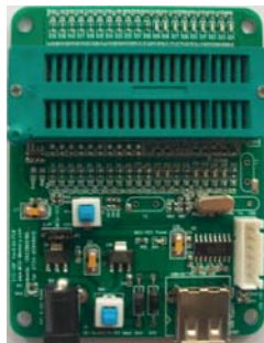
STC12/11/10/89/90系列20-pin单片机ISP下载编程工具正面
