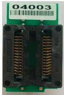
SOP-28和SOP-20的转换座 (正面)
