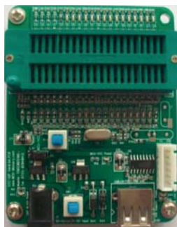
STC12/11/10/89/90系列32-pin 单片机ISP下载编程工具正面
