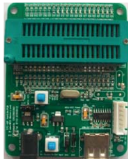
STC12/11/10/89/90系列28-pin单片机ISP下载编程工具正面
