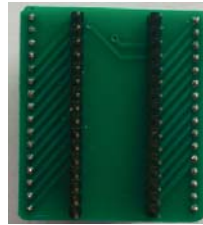
LQFP-32的转换座 (反面)
