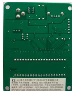
STC12/11/10/89/90系列18-pin单片机ISP下载编程工具反面 (注意有“18-pin”字样)
