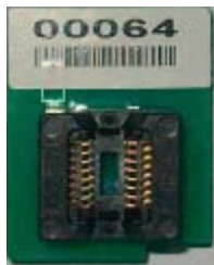
SOP-16和SOP-8的转换座 (正面)
