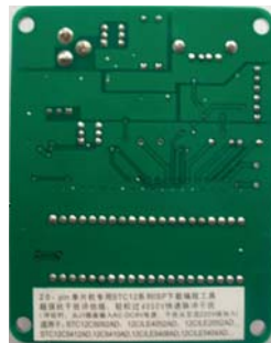
STC12/11/10/89/90系列20-pin单片机ISP下载编程工具反面 (注意有“20-pin”字样)
