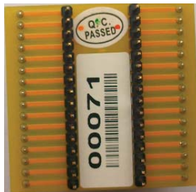
SOP-32的转换座 (反面)
