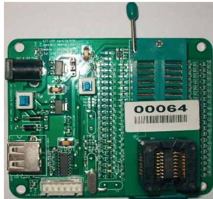
SOP-16转换座的安装
