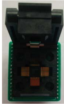
LQFP-32的转换座 (内部)
