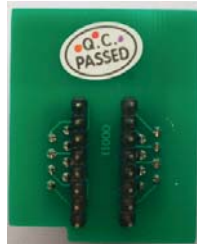
SOP-16和SOP-8的转换座 (反面)
