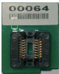
SOP-16和SOP-8的转换座(正面)
