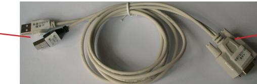
连接RS-232串行接口和STC-ISP下载编程工具的连接线(由STC提供)
