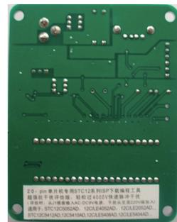
STC12/11/10/89/90系列20-pin单片机ISP下载编程工具反面
