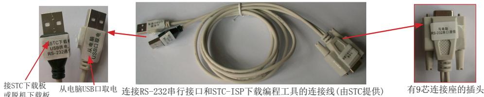
连接上图中STC提供或用户自己制作的连接线中有9芯连接座的插头
