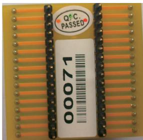
SOP-32的转换座(反面)
