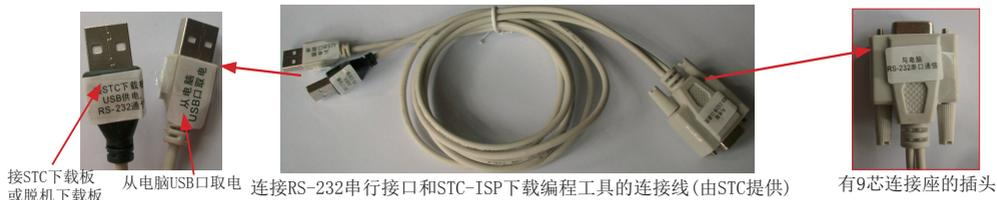
连接上图中STC提供或用户自己制作的连接线上有9芯连接座的插头
