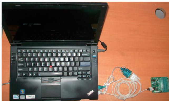
STC-ISP下载编程工具其实就是单片机通过RS-232转换器连接到电脑完成下载编程用户程序工作的。
