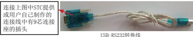
有些笔记本电脑没有标准RS-232串行口，需一条USB-RS232转换线(如左图所示)。有些USB-RS232转换线，不能兼容，请尽量选择用CH340/CH341做的USB-RS232转换线或让STC帮你购买经过测试的转换线。
