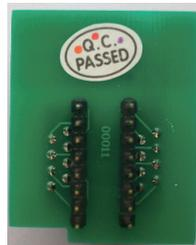
SOP-16和SOP-8的转换座(反面)
