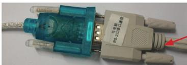
连接线上有9芯连接座的插头插入USB-RS232转换线的相应插座中
