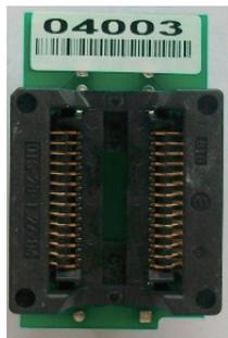
SOP-28和SOP-20的转换座(正面)
