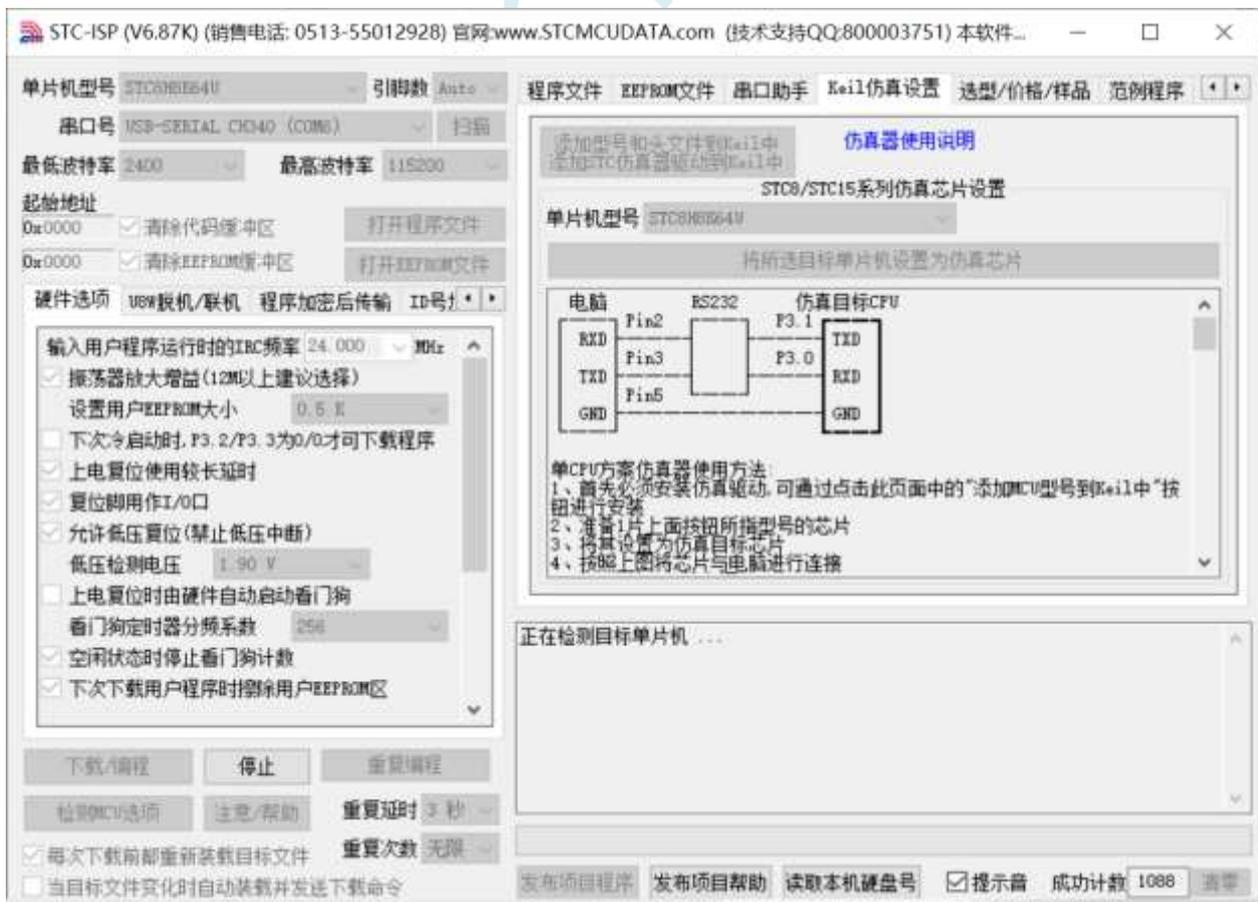
接下来需要按一下 STC 通用 USB 转串口工具上的“电源开关”给 MCU 供电【冷启动】，即可开始制作仿真芯片。
