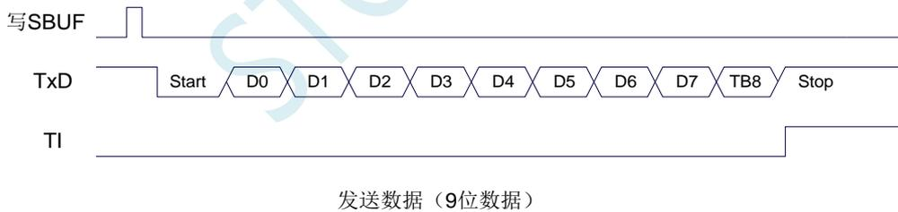
9 位数据模式时，一半个停止位后产生 RI 中断请求，如下图所示：
