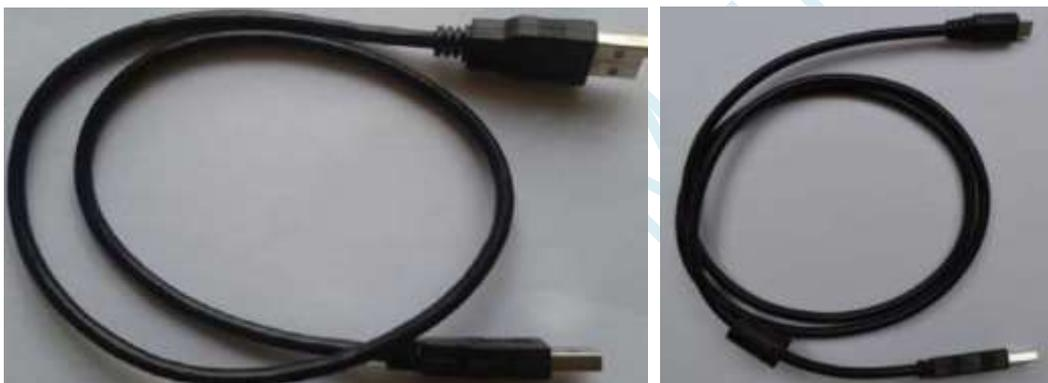
注意：此 USB 线为我公司特别定制的 USB 加强线，可确保直接用 USB 供电时能够下载成功。而市面上一些比较劣质的两头公的 USB 线，内阻太大而导致压降很大（如 USB 空载时的电压为 5.0V 左右，当使用劣质的 USB 线连接 U8W/U8W-Mini/U8/U8-Mini，到我们的下载板上的电压可能降到 4.2V 或者更低，从而导致芯片处于复位状态而无法成功下载）。
