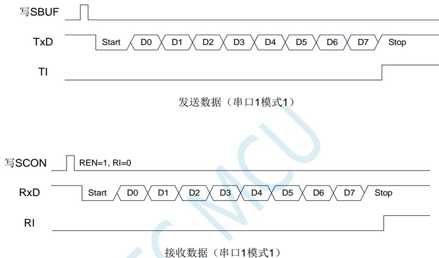
串口 1 的波特率是可变的，其波特率可由定时器 1 或者定时器 2 产生。当定时器采用 1T 模式时（12 倍速），相应的波特率的速度也会相应提高 12 倍。
